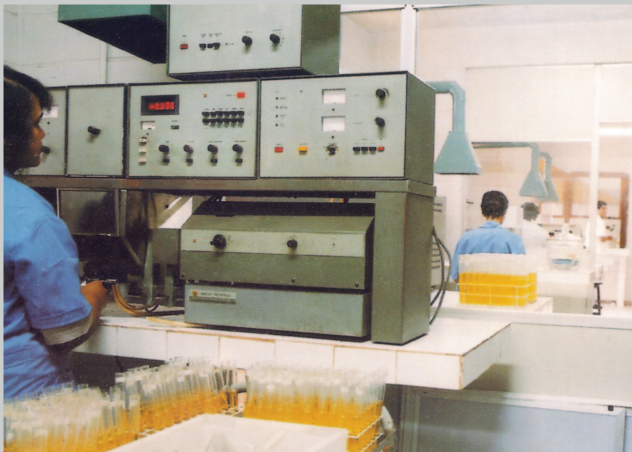
1971- O Químico Marcelo Cavalcante instala o sistema de Geração de Hidretos/AA para determinação de sub-traços de selênio, antimônio e telúrio, o primeiro no país. Instala também o sistema de geração de vapor para determinar mercúrio. (Foto ao lado)
