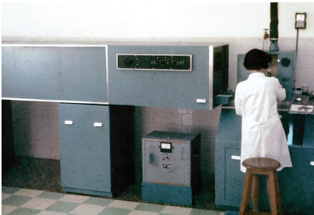
Espectrômetro Jarrell-Ash, um dos primeiros que surgiram no mercado, instalado no Geolab em 1968.
